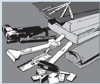
1 Alles bereit? PE-Folie und Klebeband. Als Werkzeug benötigen Sie: Zollstock, Bleistift, Stichsäge, Fuchsschwanz, Fäustel, Setzlatte, Zugeisen, ZIRO-Schlagklotz, Abstandskeile und Trittschalldämmung.
