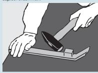
B Die letzte Dielenreihe wird mit dem Zugeisen längsseitig und mit dem ZIRO-Schlagklotz stirnseitig zusammengetrieben.
