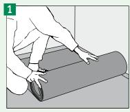
Vor Beginn der Verlegung bereitlegen: PE-Folie, Klebeband, Rollenkork als Trittschall-Dämmung, Zollstock, Bleistift, Stichsäge, Fuchsschwanz, Fäustel, Stemmeisen, Winkel, Zugeisen, Schlagholz u. Abstandskeile.
